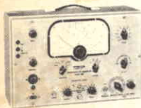
GENERATORE DI SEGNALI TV mod. 222 volubatore - calibratore generatore di barre orizzontali
