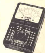
PRATICAL 10 Analizzatore portatile 10000 ohm/volt
